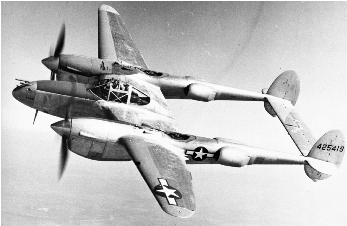
[fig. 3] L'avion Lockheed P-38 L « Lightning » Ce bimoteur était surnommé « double queue » à cause de son double fuselage. Il n'avait qu'un pilote. (Lockheed Photo J. Fry Productions San Diego CA).
