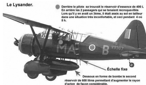
[fig. 4] L'avion Lysander, surnommé « Lizzy » capable d'atterrir et de décoller sur une courte distance. Il était non armé et pouvait transporter 2 voire 3 personnes en plus du pilote. C'est ce type d'avion qui fut utilisé sur les terrains clandestins de Villevêque codé INDIGESTION et de Corné, codé SIGNAC.
